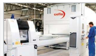
KOMPLETNO AUTOMATIZOVANA LINIJA ZA FARBANJE I SUŠENJE ELEMENATA.
